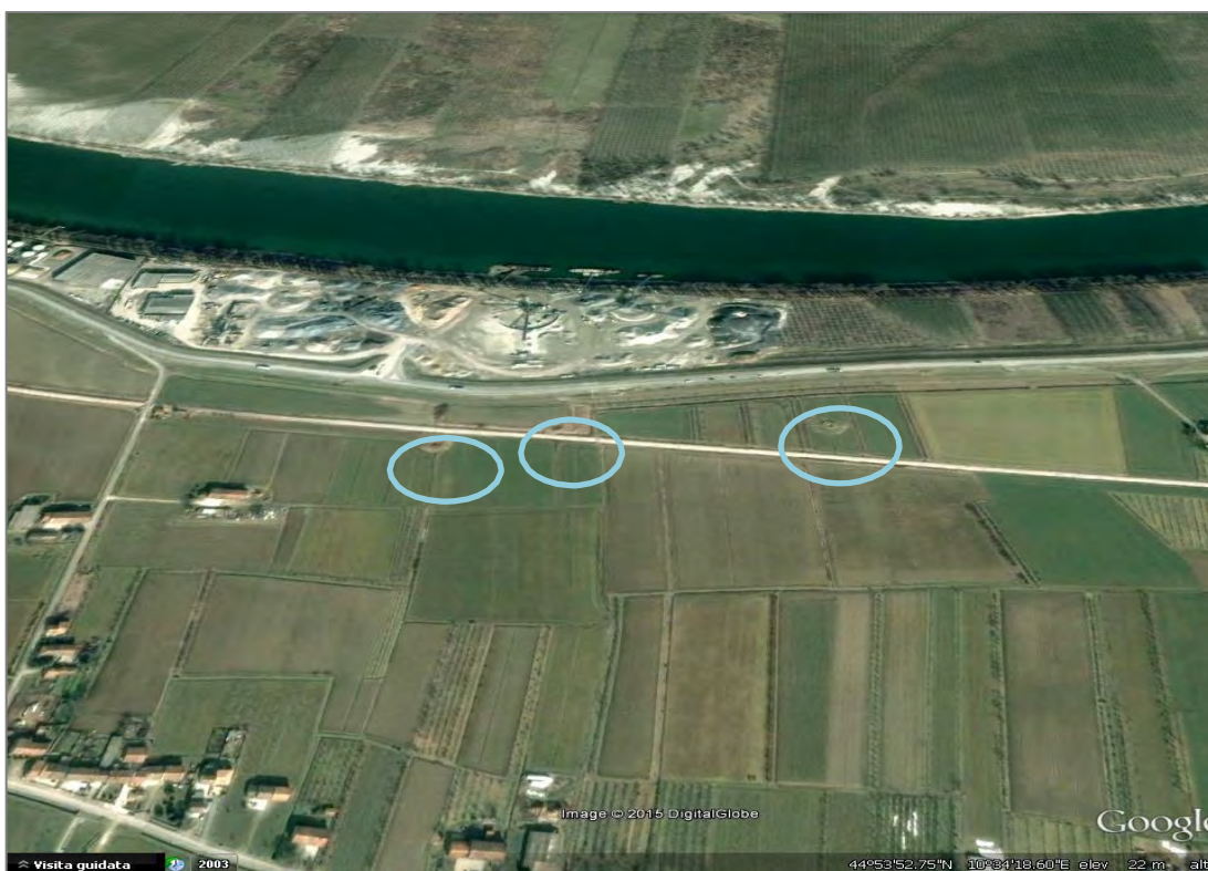
Figura 2-1 - Bicchieri di fontanazzo tra Boretto e Pieve di Saliceto . fotografia del 2003 (fonte: documento di indirizzo alla progettazione)
